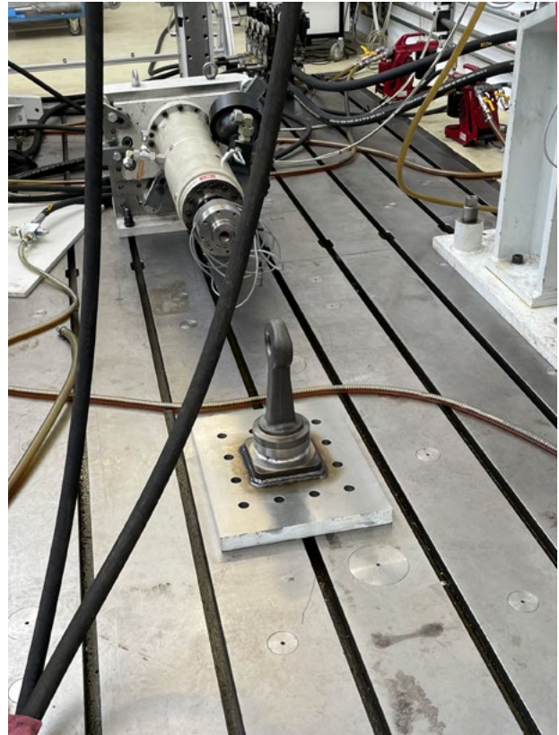
Eigene Forschung und Entwicklung: Dauerschwingversuch einer neuen Zugöse Own research and development: endurance testing of a new drawbar eye
