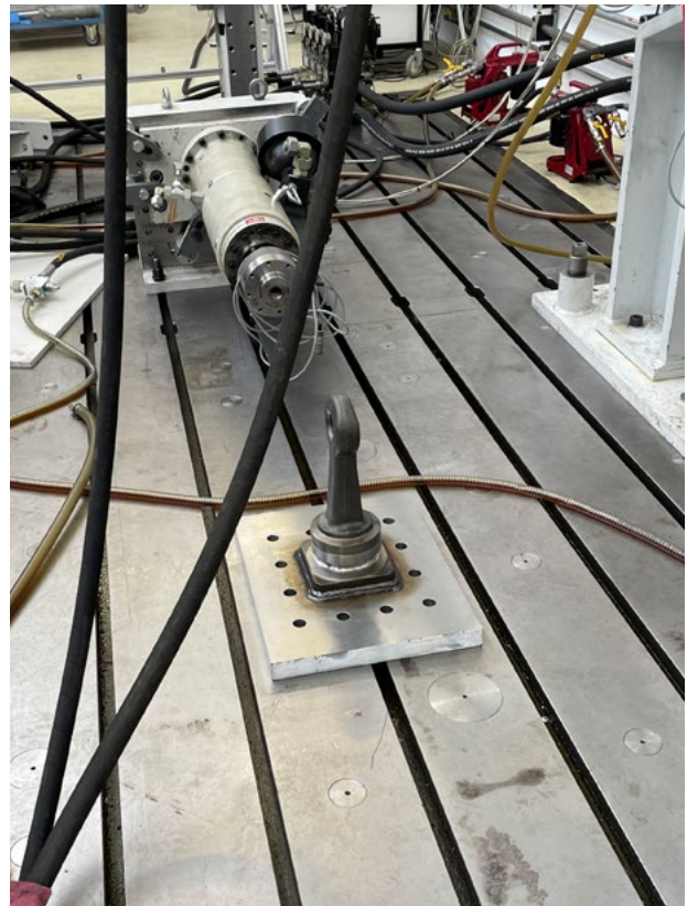
Eigene Forschung und Entwicklung: Dauerschwingversuch einer neuen Zugöse Own research and development: endurance testing of a new drawbar eye
