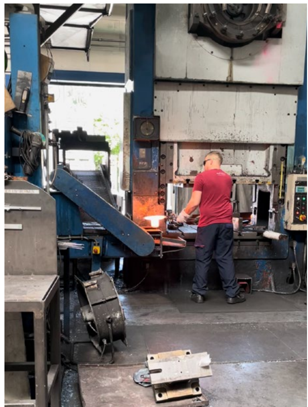
Rühlicke-Produktionsstätte in Österreich: Schmiedeprozess von Zugsattelzapfen Rühlicke production facilities in Austria: Forging of a king pin
