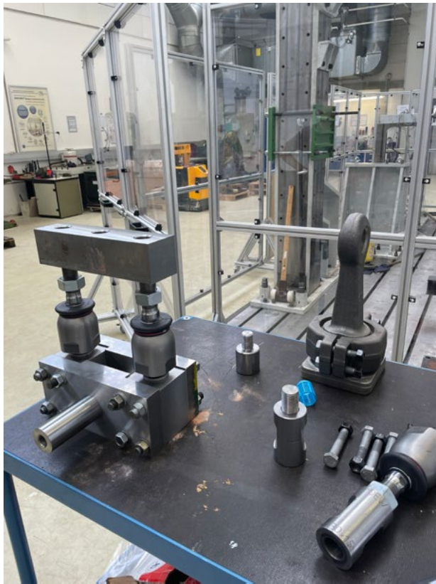
Eigene Forschung und Entwicklung: Dauerschwingversuch einer neuen Zugöse Own research and development: endurance testing of a new drawbar eye
